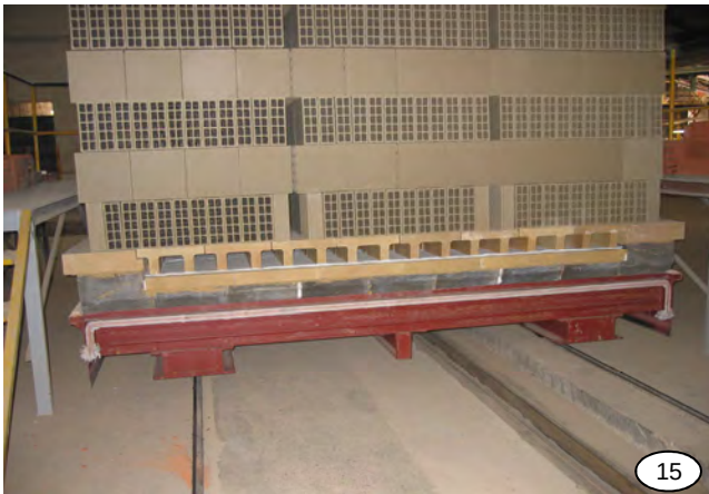
15 Kiln CAR type 106: in operation Ofenwagen für einlagigen Brand Typ 106 im Betrieb Вагонетка тип 106: в работе
